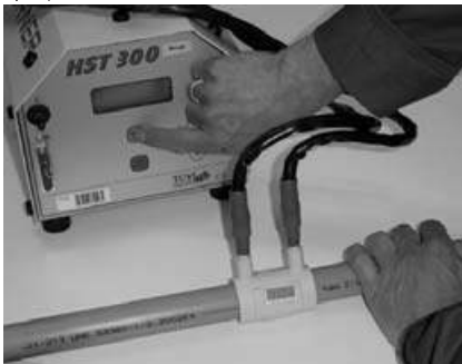
Fig. 7 Se conectează cablurile la contacte. Se introduc voltajul și timpul necesar efectuării sudurii în aparatul de electrofuziune. Datele se pot citi de pe eticheta cu coduri de bare de pe mufă. Se pornește aparatul. Pregătirea suprafețelor pentru sudare Se taie drept capetele țevii cu ajutorul unei foarfeci. Se îndepărtează stratul exterior oxidat cu ajutorul lamei de curățat și se șterge cu ajutorul unui șervețel absorbant și care nu lasă scame, precum și cu ajutorul unui agent de curățare (exp. alcool).
