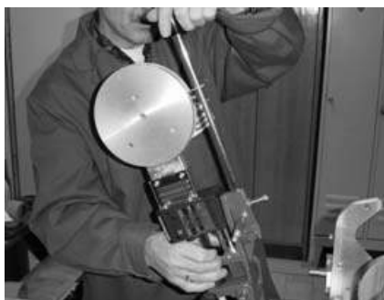
Fig. 1 Montarea elementului de încălzire în suport
