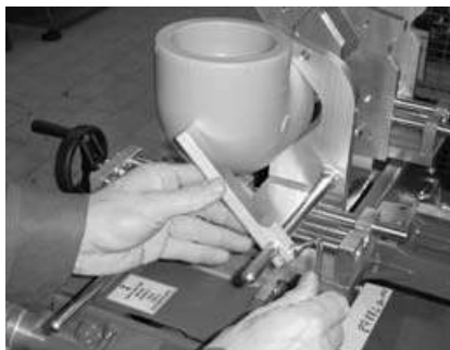
Fig. 7 Se modifică poziția bacului de fixare pentru fixarea fittingului Adjust the stop to hold the fittings
