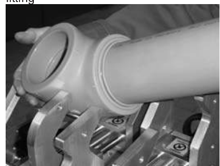
Fig. 12 După scurgerea timpului de răcire se îndepărtează piesa sudată din clemele de prindere. Remove the welding joint after the end of the cooling time from the clamping jaws
