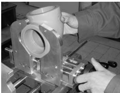
Fig. 6 Se amplasează și se aliniaza fittingul în clema de fixare. Place and adjust the fitting in the clamping jaw
