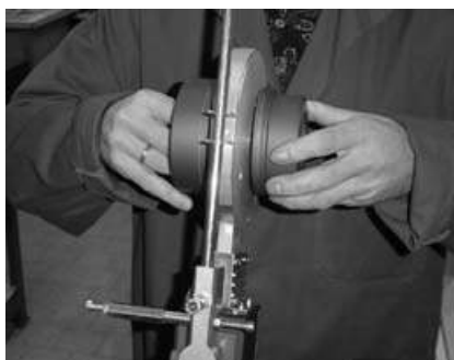
Fig. 2 Amplasarea mufelor și mandrinelor pe elementul de încălzire
