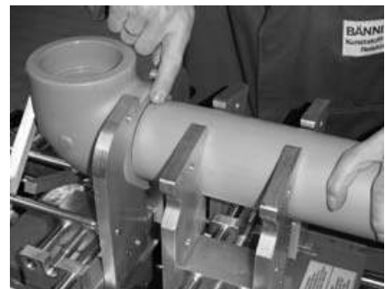
Fig. 8 Se aliniaza țeava și fittingul astfel încât să fie una în fața celeilalte
