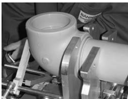
Fig. 11 Se deplasează bacurile până la atingerea adâncimii necesare pentru sudură Move the machine slides up to stroke end
