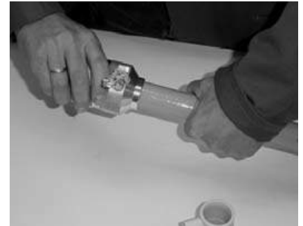
Fig. 3 În cazul țevilor de tip Stabi trebuie să se îndepărteze folia de aluminiu înainte de efectuarea sudurii. On Bänninger Stabi-Pipes, the alu-minum coating must be peeled off before jointing.
